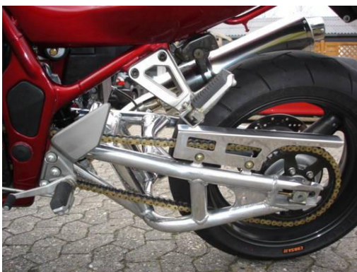
Suzuki GSF 1200 Turbo 100 mm länger, Kettenspanner 80 mm
