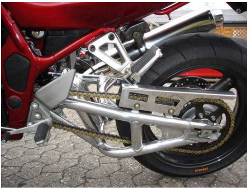
Suzuki GSF 1200 Turbo 100 mm länger, Kettenspanner 80 mm
